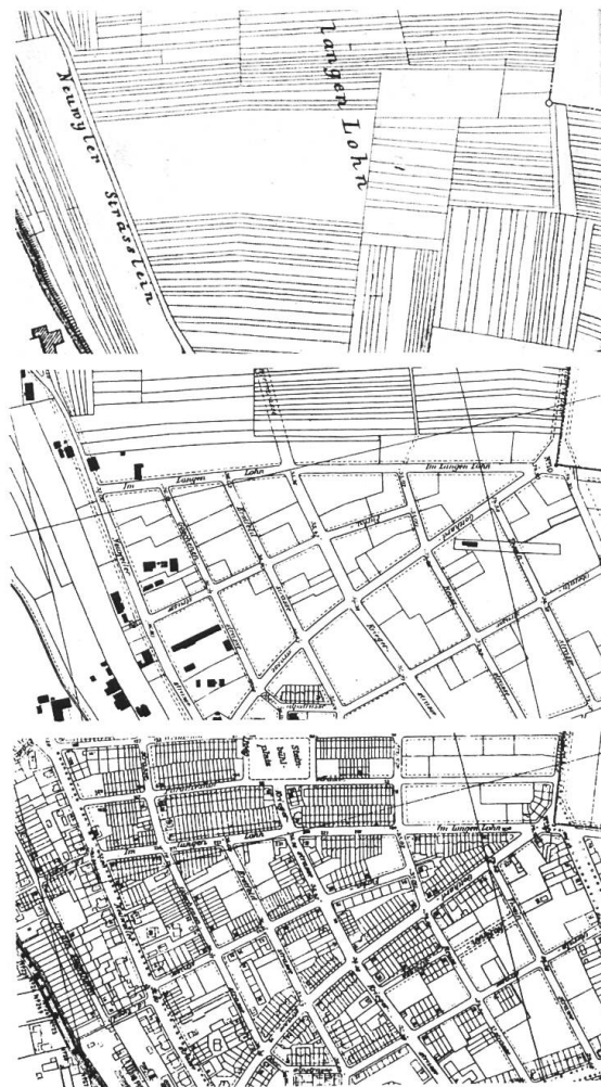
Abb. 2 Die Eigentumsgrenzen eines Aussenquartiers von Basel zur Zeit der landwirtschaftlichen Nutzung, nach der Umlegung für Bauzwecke und nach der Parzellierung und Bebauung.
