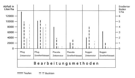
Abb. 4 Einzelergebnisausschnitt: Der Zusammenhang Bodenbearbeitungsmethoden, erodierender Oberflächenabfluss und erodiertes Bodenmaterial (nach *Rüttimann* 1993). Die Pflug-Bodenbearbeitung zeigt hohe Abflussraten und hohe Bodenabtragsnote.
