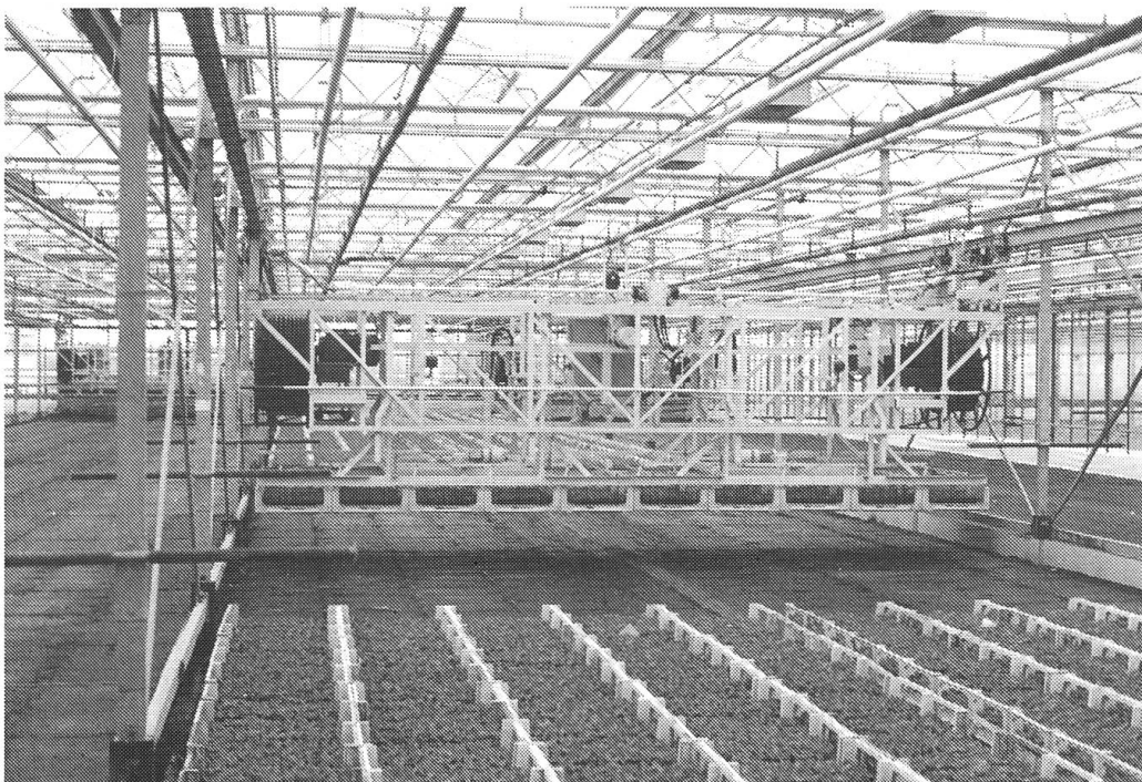
Abb. 3 Im Stecklingsbetrieb FIDES in Maasland (Holland) verrichtet ein computergesteuerter Roboter den Transport der Kisten zur Versandhalle.
