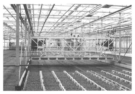
Abb. 3 Im Stecklingsbetrieb FIDES in Maasland (Holland) verrichtet ein computergesteuerter Roboter den Transport der Kisten zur Versandhalle. Foto: U. Lange
