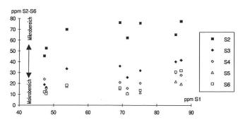
Abb. 8 Übergänge von Makrozu Mikrobereich am Beispiel der Calcium-Konzentrationsentwicklung der Parallelsaugkerzen S2-S6 als abhängige Grössen der Saugkerze S1. Die Punktwolke zeigt, dass eine Zweiteilung des Umsatzprozessgeschehens unzulänglich ist
