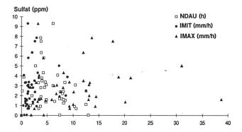
Punktwolke; ausgewählt wurde die Sulfat-Konzentration im Regen als abhängige Grösse, die mittlere und maximale Regenintensität sowie die Ereignisdauer sind als unabhängige Grössen eingetragen. Obwohl in speziellen Fällen auch eine direkte Abhängigkeit der Sulfat-Konzentration von der Regenintensität beobachtet wurde (*Bloxam* 1984), dürften doch mehrheitlich signifikante Korrelationen und Regressionen erwartet werden; dies ist aber nicht der Fall.
