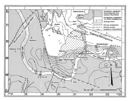
Abb. 1 Tektonische Karte von Bad Säckingen und Umgebung (nach Geol. Karte Baden-Württemberg 1:25 000, Blatt 8413 Bad Säckingen [vorläufige, vereinfachte Ausgabe], Suter 1915, Heusser 1926, Hauber 1980; unveröffentl. Unterlagen der Schluchseewerk AG, der Rheinkraftwerk Säckingen AG und eigenen Untersuchungen).
