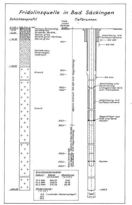
Abb. 1 Schichtenprofil und Ausbau der Fridolinsquelle
