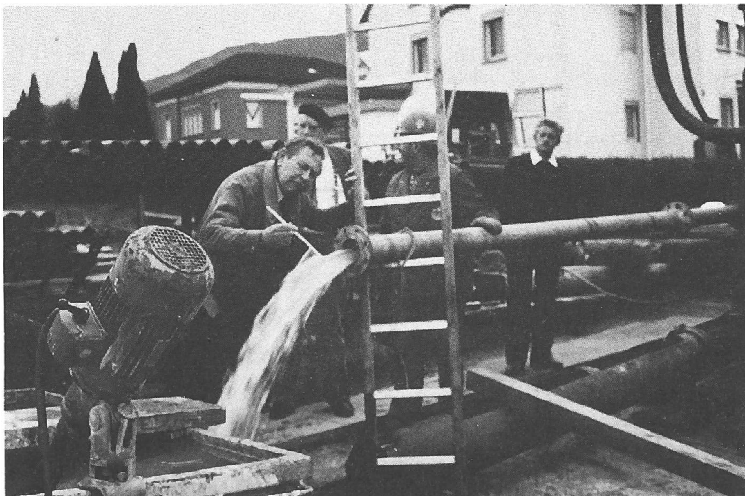
Abb. 2 Temperaturmessung während des ersten Pumpversuchs im März 1983 durch Prier (links) und Sauer (rechts). Bilder: H. Prier
