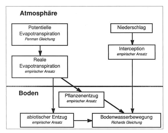
Abb. 1 Konzeption des Bodenwasserhaushaltsmodells
