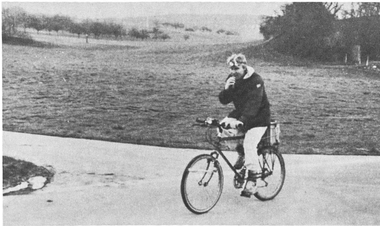
Abb. 2 J. Hosang an der Ankunft nach einer frühmorgendlichen Temperaturmessung, beim Sprechen der Ankunftszeit auf das Diktaphon. Am Vorderrad ist die Temperatursonde sichtbar, auf dem Gepäckträger befindet sich das Registriergerät.
