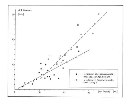
Abb. 6 Methodischer Vergleich zwischen empirischen pET-Werten von HAUDE und gemessenen Verdunstungswerten des PICHE-Evaporimeters. Das unterschiedliche Messprinzip der beiden Methoden zeigt keine Korrelation. Als stark differenzierender Faktor führt der Windeinfluss insbesondere zu einer jahreszeitlichen Abhängigkeit, welche durch die beiden Trendgeraden verdeutlicht werden soll.
