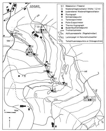
Abb. 1 Messnetz zur komplexen Erfassung des Gebietswasserhaushaltes
