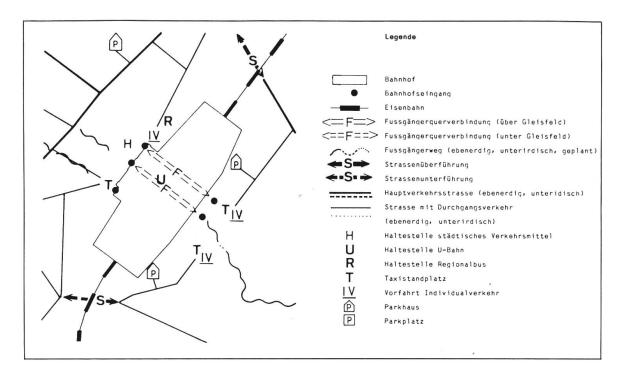
Abb. 1 Schema der zukünftigen Verkehrsanbindung des Düsseldorfer Hauptbahnhofs nach dem vollständigen Umbau. (Entwurf Verfasser)
