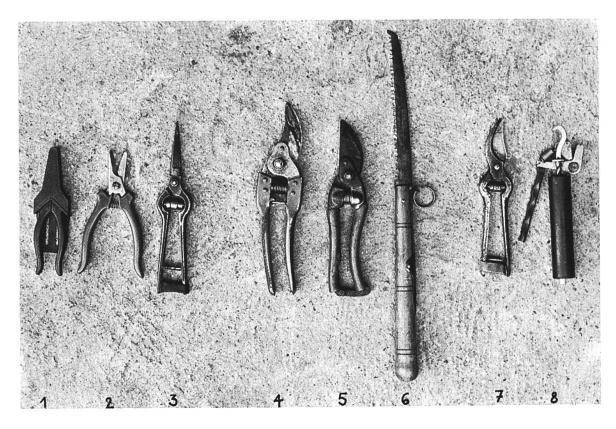
Abb. 6 Verschiedene Rebscheren: 1. Ultramoderne Rebschere mit Kunststoffgriff und benutzerfreundlicher Spitze 2. wie 1., aber ohne Klingenschutz 3. die traditionelle, spitze Schere 4. und 5. zwei Schnidschären 6. zusammenklappbare Säge (für dicke Zweige) 7. die traditionelle, runde Herbschterschär 8. Bindzange.
