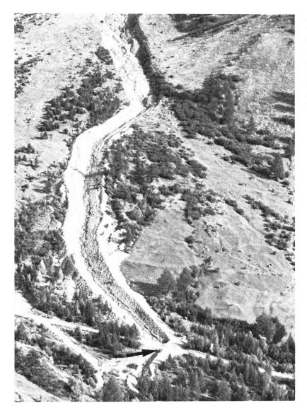
Abb. 9 Schwemmkegel des Stammbachs mit ausgebaggertem Bachbett nach dem Wassertaschenausbruch von 1976. Das Durchlassrohr unter der Strasse Blatten-Gletscherstafel ist mit einem Pfeil markiert.
