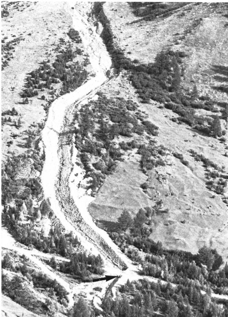
Abb. 9 Schwemmkegel des Stammbachs mit ausgebaggertem Bachbett nach dem Wassertaschenausbruch von 1976. Das Durchlassrohr unter der Strasse Blatten-Gletscherstafel ist mit einem Pfeil markiert.
