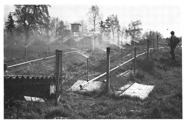
Abb. 3: Beregnungsanlage in Betrieb. Der Regen wird halbkreisförmig und im Bogen von den Niederdruckdüsen ausgeprüht.
