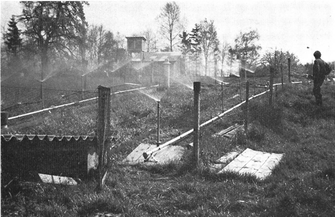
Abb. 3: Beregnungsanlage in Betrieb. Der Regen wird halbkreisförmig und im Bogen von den Niederdruckdüsen ausgepüht.
