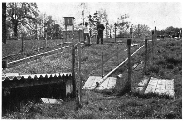
Abb. 2: Testfläche T1 mit der aufgestellten Beregnungsanlage. Um die Messparzellen ist das auf kleinen Standfüssen ruhende Rohrsystem mit den aufgesetzten Standrohren und Regnerdüsen ausgelegt. Die Wasserversorgung erfolgt von dem Gummicontainer am rechten oberen Bildrand.
