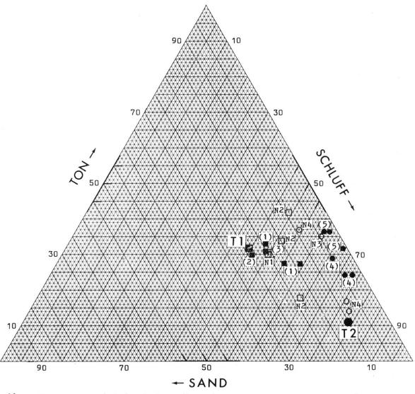
Abb. 5: Körnungsartendreieck mit Darstellung der Korngrössenzusamensetzung des Ausgangssubstrats und des abgetragenen Bodenmaterials der beiden Standorte T1 und T2
