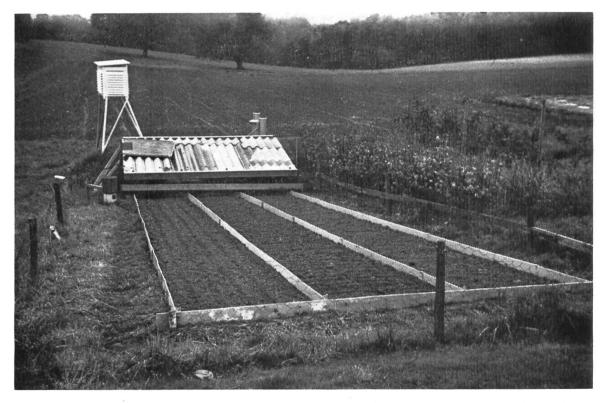
Abb. 1: Testfläche T2. Im Vordergrund sind die drei Versuchsparzellen zu sehen; rechts P2/1, die richtungslos bearbeitete und vegetationsfreie Bezugsparzelle, in der Mitte P2/2, hangparallel bearbeitet, links P2/3, im Gefälle bearbeitet. Im Hintergrund sind der Unterstand, in dem der Abtrag aufgefangen wird, ein Regenschreiber, ein Regenmesser und eine Wetterhütte zu erkennen.
