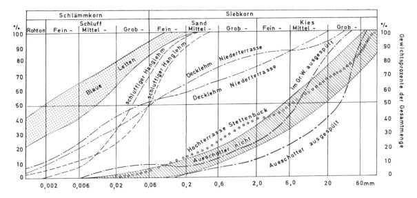
Abb. 1 Typische Kornverteilung in Tongestein und Lockergesteinen Punktraster: Bereich «Blaue Letten» Schraffur: Bereich Niederterrassenschotter Unterlagen: Stadtarchiv Lörrach
