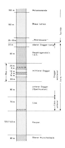
Abb. 2 Geologische Schichtenfolge und Verteilung Kalksteine/Tonsteine im Profil Mauersignatur = Kalksteine
