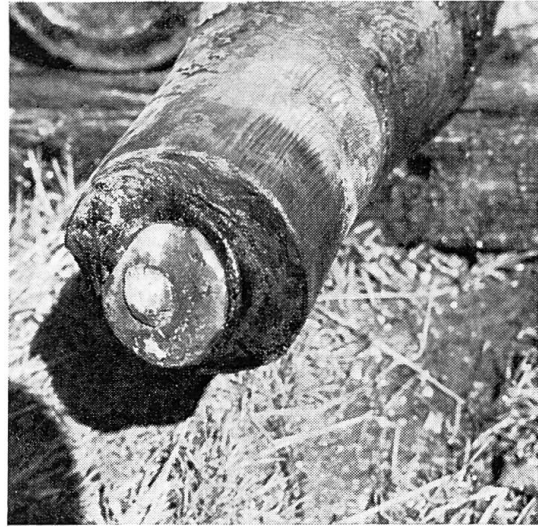
Abb. 7 Das Kopfende des Saugrohres mit Steckzylinder und links oben an der Mündung noch festsitzender Ventilklappe. Foto K. Hunziker.
