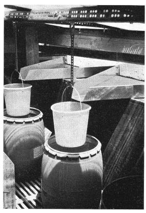
Abb. 3 Innenraum eines Unterstandes Die Aufnahme zeigt die wesentlichen Bestandteile der Ausrüstung eines Unterstandes: die trichterförmig zulaufenden Ablaufbleche und Eimer und Fässer als Auffanggefässe. (Aufnahmedatum: 14. 6. 75)
