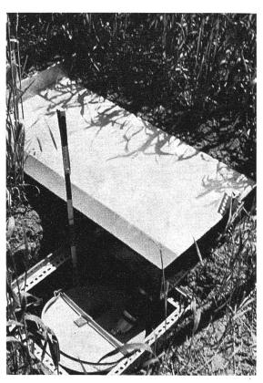
Abb. 4 Feldmesspunkt Der Messpunkt ist in einem Getreidefeld angelegt. Die Erosionsmasse wird von dem Sedimentfangblech aufgenommen und über die Sammelrinne und den Ablaufstutzen in das Auffanggefäss (Eimer) geleitet. (Aufnahmedatum: 14. 6. 75)
