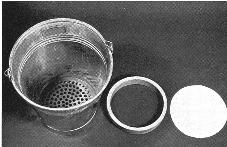
Abb. 5 Auffanggefäß eines Feldmesspunktes
