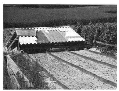
Abb. 2 Testfläche mit Unterstand und Messparzellen Deutlich ist die Unterteilung der Testfläche in drei Messparzellen erkennbar, die – mit Ausnahme der Bearbeitungsart – völlig gleichartig sind. (Aufnahmedatum: 14. 6. 75; Blickrichtung: NW)
