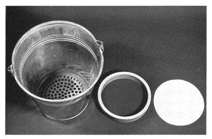
Abb. 5 Auffanggefäss eines Feldmesspunktes Das Auffanggefäss besteht aus einem Eimer, dessen Boden eine Lochplatte bildet. Auf der Lochplatte liegt Filterpapier, das durch einen Kunststoffring beschwert und seitlich abgedichtet wird. (Aufnahme von A. Bühler am 12. 6. 75)
