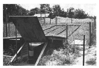
Abb. 1 Gesamtansicht einer Testfläche zur Messung der Bodenerosion Im Vordergrund ist der Unterstand zu erkennen, der drei Ablaufbleche mit je zwei gestaffelten Auffanggefässen enthält. Diese nehmen die Erosionsmasse der drei Messparzellen auf. Im Hintergrund stehen ein Regenschreiber und eine Wetterhütte. (Aufnahmedatum: 14. 6. 75; Blickrichtung: S)
