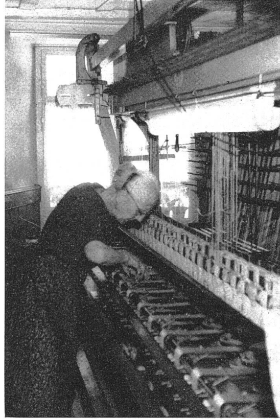
Abb. 4 Posamenterin (Jahrgang 1896) bei der Arbeit an ihrem sechsdreissigängigen Sägerstuhl. Man beachte, dass hier die alte Posamenterlampe durch eine Leuchtröhre ersetzt ist. (Aufnahme Verfasser).
