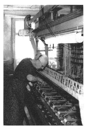
Abb. 4 Posamenterin (Jahrgang 1896) bei der Arbeit an ihrem sechsunddreissiggängigen Sägerstuhl. Man beachte, dass hier die alte Posamenterlampe durch eine Leuchtröhre ersetzt ist. (Aufnahme Verfasser).
