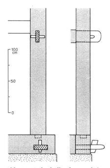
Abb. 14 Ankerbalkenkonstruktion an einem Wohnhaus. Steinbrunnle-Haut F. Vgl. Abb. 15.
