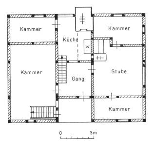
Abb. 45 Grundriss eines traufseitig erweiterten Wohnhauses mit Mittelflur. Häsingen F.
