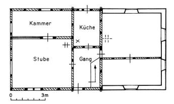
Abb. 43 Grundriss eines Kleinhauses mit durchgehendem Ankerbalken. Stube und Kammer des massiven Anbaus stammen von ca. 1930 (vgl. Abb. 40). Steinbrunnle-Haut F.
