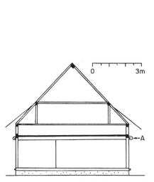
Abb. 15 Querschnitt durch ein Wohnhaus mit Ankerbalken (A). Steinbrunn-le-Haut F. Vgl. Abbildung 14 und 40.
