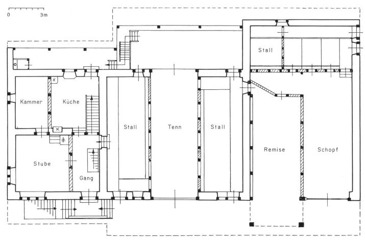
Abb. 48 Sekundärer Vielzweckbau, Wohnhaus mit dreiteiliger Scheune verbunden, späterer Anbau eines weiteren Wirtschaftsteils (Remise, Scheune, Ställe). Biel-Benken BL.
