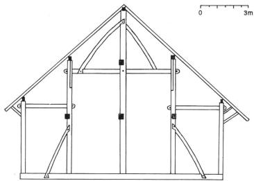
Abb. 16 Dachgerüst der mehrständrigen Scheune mit querverbindenden Ankerbalken. Wolfersdorf F (ca. 1551). (Aus: Das Bauernhaus im Deutschen Reiche, 1906.) Vgl. Abb. 4 und 17.
