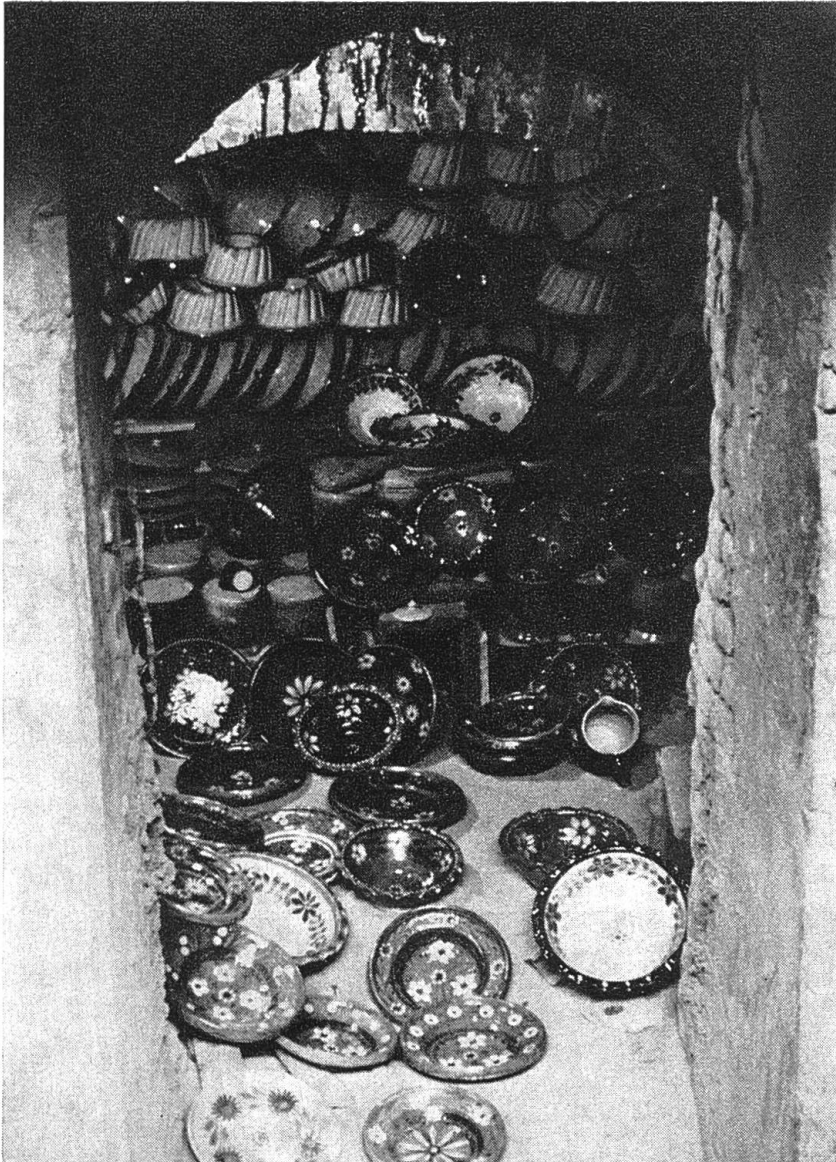
Abb. 43 Ausräumen eines Holz-Gas-Ofens.
