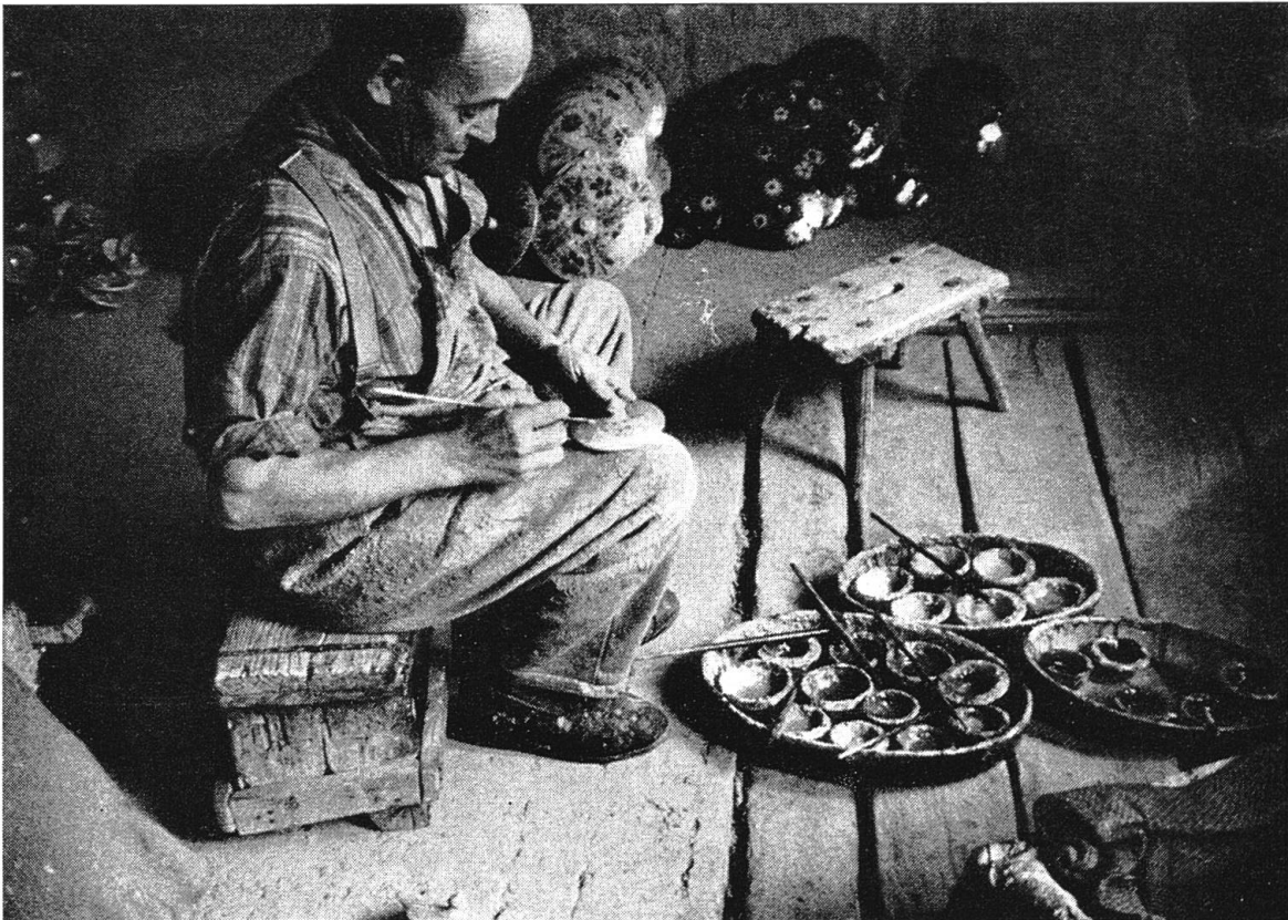
Abb. 42 Ausbessern fehlerhafter Stellen.
