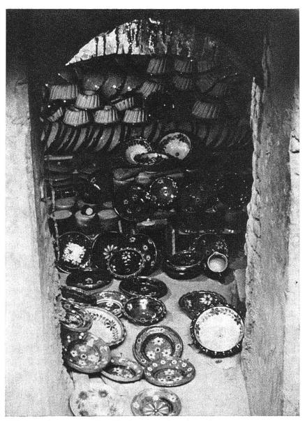
Abb. 43 Ausräumen eines Holz-Gas-Ofens.
