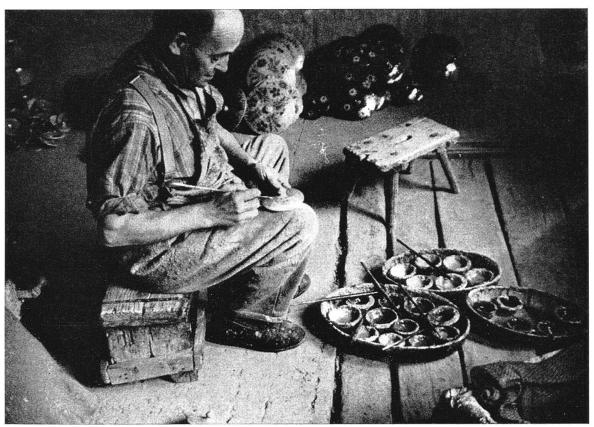
Abb. 42 Ausbessern fehlerhafter Stellen.
