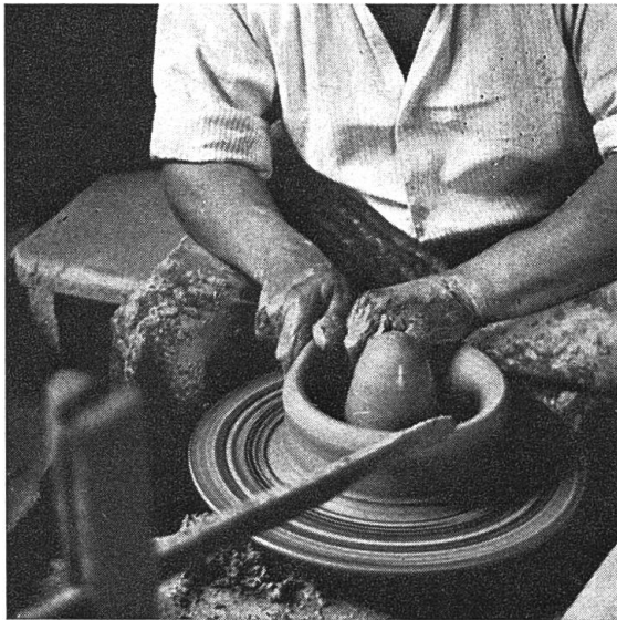
Abb. 20 Die Aussenwand wird hochgetrieben.
