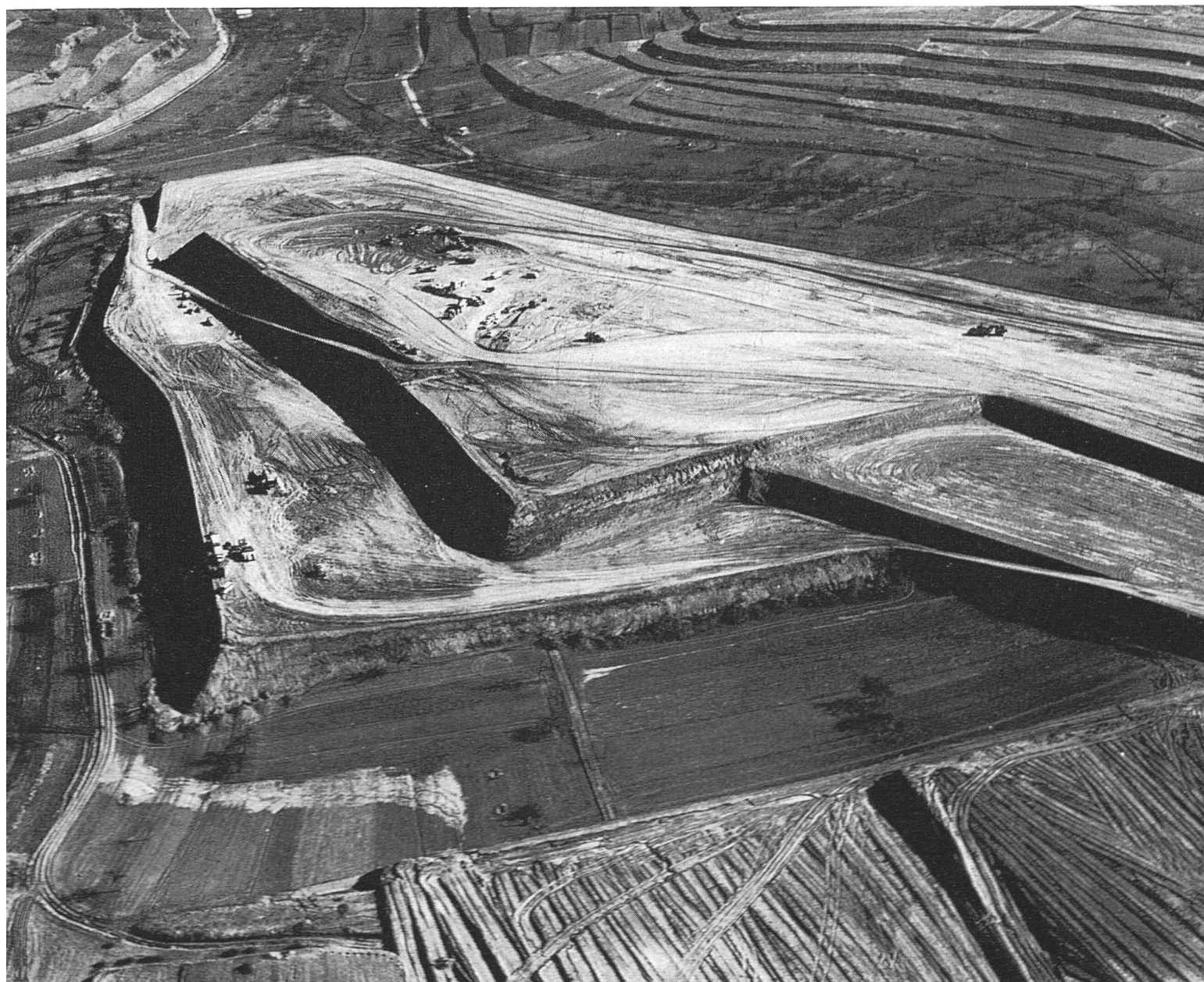
Abb. 12 Ausschnitt aus dem Grossterrassen-Rebflurbereinigungsgebiet Eichstetten-Mittlingen (östlicher Kaiserstuhl) mit 6 bis 16 m hohen Terrassenböschungen. Luftaufnahme Mitte März 1970. Man beachte das Grössenverhältnis der Maschinen und Wagen zu den Terrassenhöhen (bis zu 15 m links). Luftbild W. H. Friele. Freigegeben v. Reg.-Präs. Südbaden, Nr. P 2025—70.
