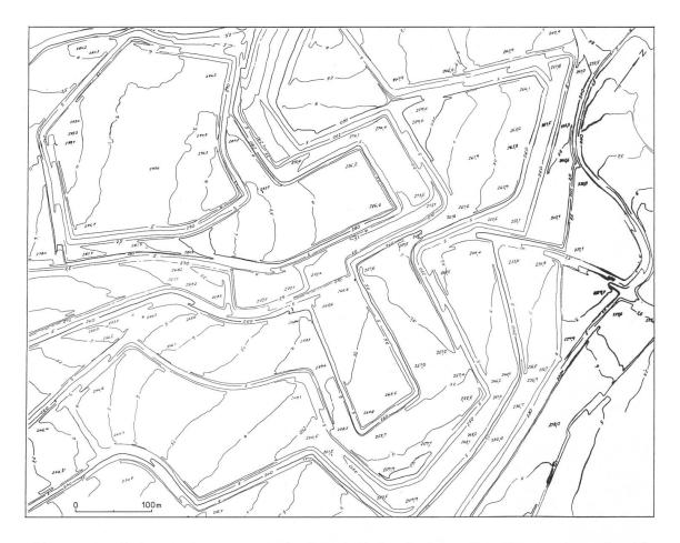
Abb. 14 Ausschnitt aus dem neuen Höhenlinienbild der fertiggestellten Grossterrassen im Rebflurbereinigungsgebiet Ihringen-West (Kaiserstuhl). Man beachte die aus der leichten Rückneigung (Querneigung) und leichten Längsneigung resultierende Diagonalneigung der neu angelegten Terrassenoberflächen nach schräg hinten sowie die geschaffenen Terrassenhöhen von bis zu 16 m (gleicher Ausschnitt wie Abb. 9 und 10). (Wiedergabe mit freundlicher Genehmigung des Flurbereinigungsamts Freiburg.)
