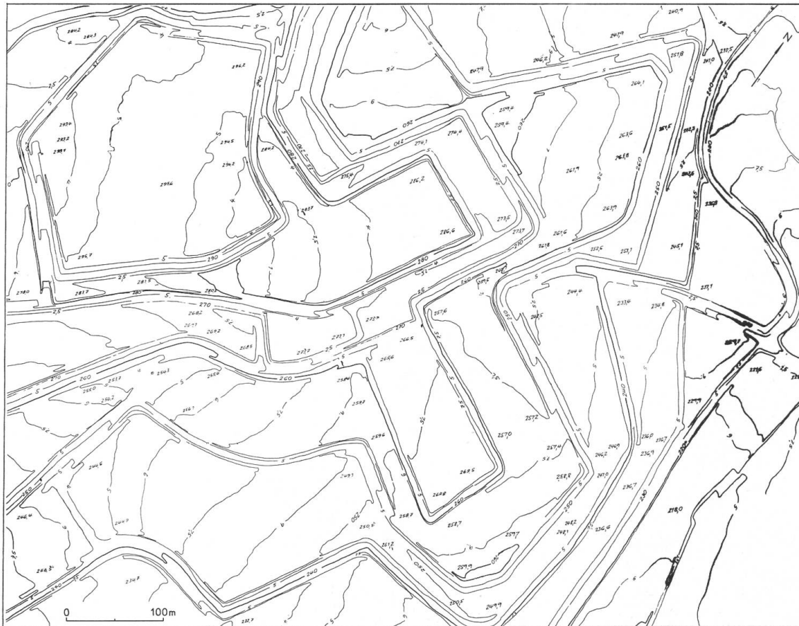
Abb. 14 Ausschnitt aus dem neuen Höhenlinienbild der fertiggestellten Grossterrassen im Rebflurbereinigungsgebiet Ihringen-West (Kaiserstuhl). Man beachte die aus der leichten Rückneigung (Querneigung) und leichten Längsneigung resultierende Diagonaleigung der neu angelegten Terrassenoberflächen nach schräg hinten sowie die geschaffenen Terrassenhöhen von bis zu 16 m (gleicher Ausschnitt wie Abb. 9 und 10). (Wiedergabe mit freundlicher Genehmigung des Flurbereinigungsamts Freiburg.)
