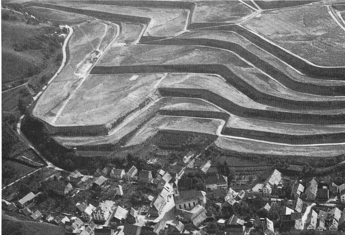
Abb. 3 Ausschnitt aus dem Grossterrassen-Rebflurbereinigungsgebiet Schelingen-Rebberg (Kaiserstuhl). Etwa gleiches Gebiet wie Abb. 2. Zustand September 1967 nach der Beendigung der Terrassenschub- und Planierungsarbeiten, jedoch vor dem neuen Rebenaufbau. Man beachte die geometrische Linienführung der durchgehenden neuen Grossterrassen mit Böschungshöhen zwischen 6 und 12 m. (Luftbild W. H. Friese. Freigegeben v. Reg.-Präs. Südbaden, Nr. P 585—67.)
