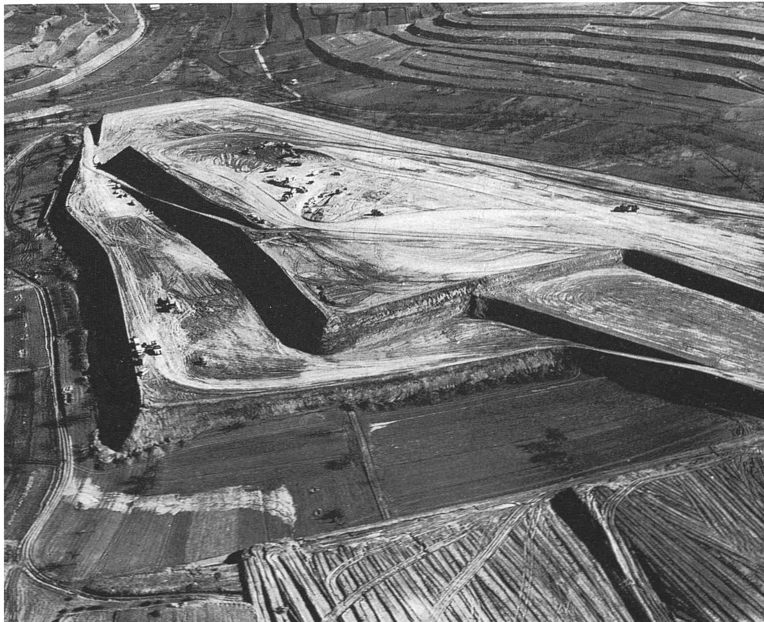
Abb. 12 Ausschnitt aus dem Grossterrassen-Rebflurbereinigungsgebiet Eichstetten-Mittlingen (östlicher Kaiserstuhl) mit 6 bis 16 m hohen Terrassenböschungen. Luftaufnahme Mitte März 1970. Man beachte das Grössenverhältnis der Maschinen und Wagen zu den Terrassenhöhen (bis zu 15 m links). Luftbild W. H. Friese. Freigegeben v. Reg.-Präs. Südbaden, Nr. P 2025—70.
