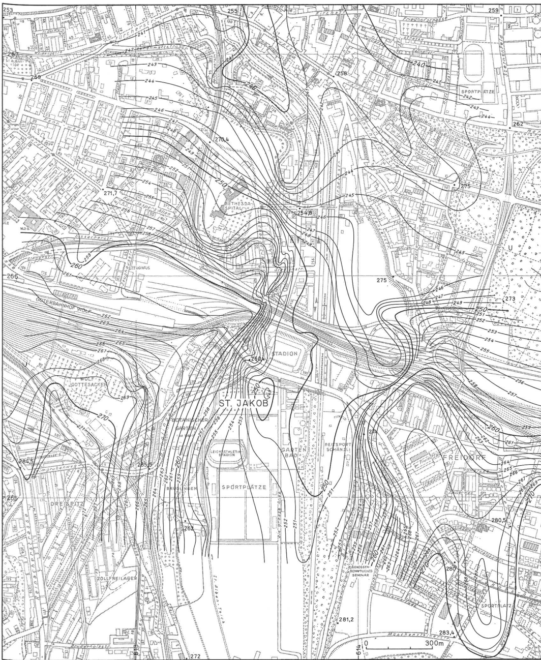
Abb. 3 Das Relief der Felsoberfläche unter den Schottern im Gebiet St. Jakob-Schänzli östlich von Basel. Kurven in Metern ü. M.
