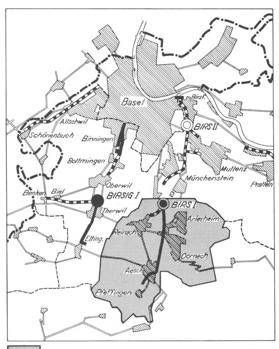
Gemeinden deren Abwasser der Abwasserreinigungsanlage Birs I zugeleitet werden
