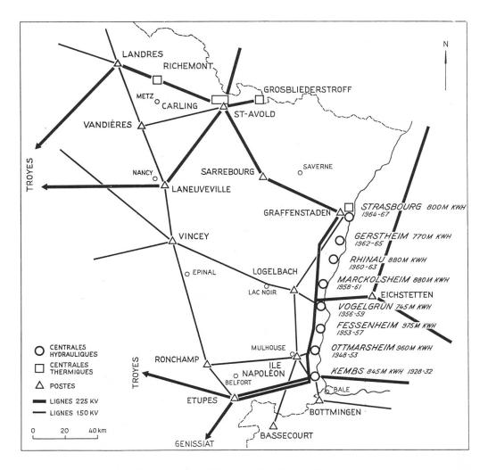
Fig. 4. Les centrales rhénanes et le réseau d'interconnection.
