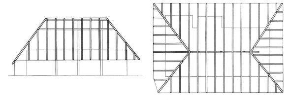
Abb. 10 Parallele Rafenlage, Entfelden AG.
