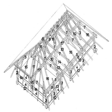
Abb. 3 Hochstudbau mit Bezeichnungen der einzelnen Teile: 1 Hochstud, 2 Eckständer, 3 Wandständer (Feldersäule), 4 Wandfüllung (Bohlen, Lehmgeflecht), 5 Wandpfette (Rähm), 6 Fusspfette, 7 Spannbaum (Querriegel), 8 Firstbalken, 9 Unterfirst, 10 Sperrafen, 11 Windstreben, 12 Schwelle, 13 Kranzbalken, 14 Querriegel, 15 Bug, 16 Rafen.
