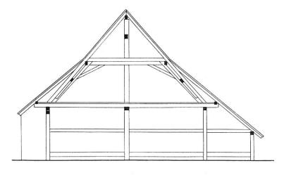
Abb. 14 Hochstud-Sparendach mit durchgehender Hochstud, Olten SO.
