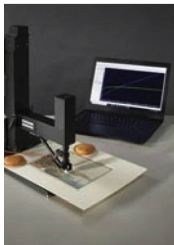
Determinare la durata di esposizione di un'opera grazie a Micro Fading Testing
