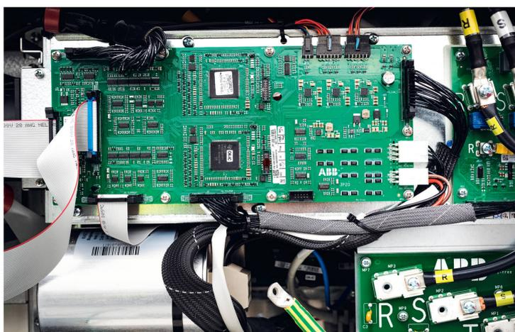
100 Kilowatt Leistung: Das Innenleben des Photovoltaik-Wechselrichters.
