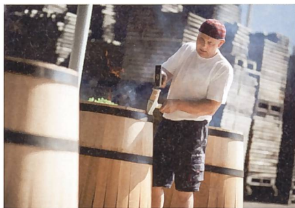
Küfermeister Gerhard Benninger fertigt die Barriques aus dem Holz der Edel-Kastanie in der hauseigenen Käferei.
