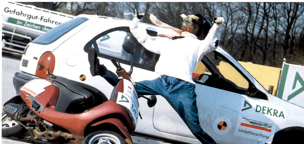
Der Crash-Test belegt es: Bei einer Kollision ist der Kopf wegen des Aufpralls am Autodach besonders gefährdet.
