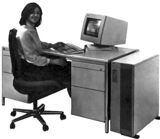
Der neue leistungsstarke NCR 9100 Universal-Computer mit bis 1 MB Memory, dynamischem «Cache-Memory», Winchesterdisc, Streamertape und Disketten/Kassetten braucht keinen Computerraum.
