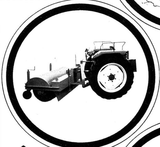
Wira- und Kobra-Kehrmaschinen mit Wassersprühvorrichtung, Sammelbehälter oder zum Seitwärtskehren, leisten eine saubere Arbeit. Einfacher Anbau an jeden Traktor.
