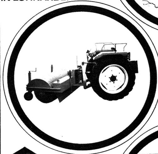
Wira- und Kobra-Kehrmaschinen mit Wassersprühvorrichtung, Sammelbehälter oder zum Seitwärtskehren, leisten eine saubere Arbeit. Einfacher Anbau an jeden Traktor.
