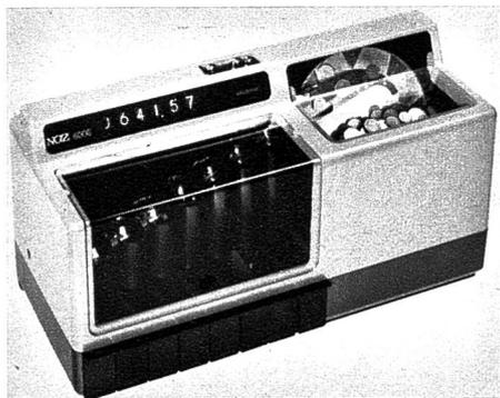
Die Maschine verfügt über 8 Schächte mit austauschbaren Münzkästen. Pro Minute werden bis zu 600 Einheiten sortiert und aufaddiert. Ein Digital-Anzeiger orientiert durch klare Zahlen über das Total.
