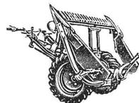
**In einer Maschine vereint**, der wendige 8-Pferd- Traktor im Gesamtgewicht von 350 kg, das durch Zusatzgewichte auf eine halbe Tonne erhöht werden kann, der wie zwei Pferde zieht, und der
