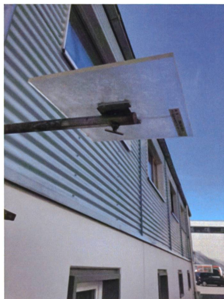
Figur 1 : Installierte Staubfangplatte an der Seitenwand der ZwiLag auf ca. 2m Höhe über Boden. Sämtlicher Staub und Partikel, die durch Wind und Witterung auf der Fettschicht kleben bleiben, werden alle 2 Wochen auf ihren Radionuklidgehalt analysiert. Foto: Patricia Kramer (04-2022).
