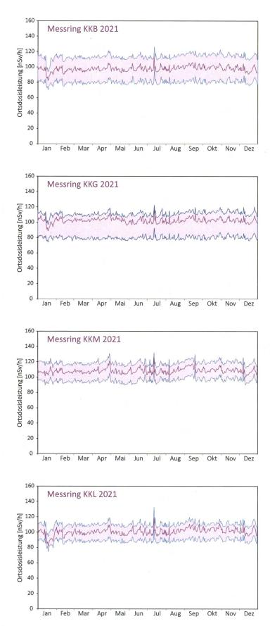
Figur 3 : Maxima, Minima und Medianwerte der Tagesmittelwerte der Sonden der Messringe KKB, KKG, KKL und KKM im Jahr 2021.
