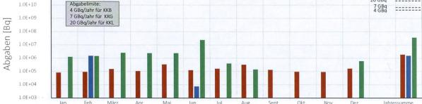
Fig 1.b (Teil 1): Abgaben der schweizerischen Kernkraftwerke an die Atmosphäre und das Abwasser im Jahr 2021 aufgeschlüsselt nach einzelnen Monaten. Bei fehlenden Balken in den Figuren liegen die bilanzierten Werte unterhalb des dargestellten Wertebereichs.
