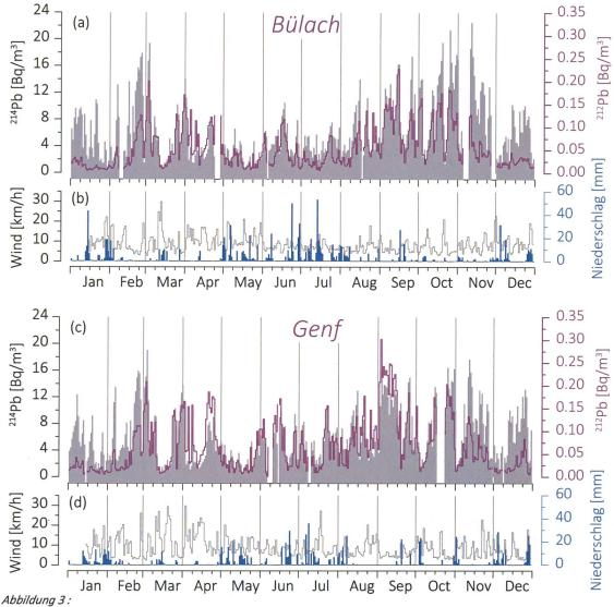
Zeitreihe der Tagesmittelwerte der <sup>214</sup>Pb und <sup>212</sup>Pb Aktivitätskonzentrationen der Stationen Bülach und Genf für das Jahr 2021, zusammen mit den Tagesmittelwerten der Windgeschwindigkeiten und der 24h-Niederschlagssumme.
