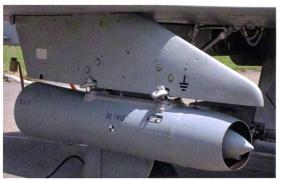
Figur 2: Höhenluftfilter-Aggregate: Detail-Aufnahme eines Sammelgerätes.
