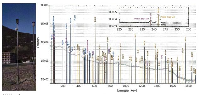
Spektrum der Messstation Bellinzona vom 28. Dezember 2021 um 12:00 Uhr. Die Linien von 214 Pb und 214 Bi aus der Uran-Radium-Zerfallskette sind gelb und blau markiert, alle anderen rot. Der Bereich um die Hauptlinie von 212 Pb aus der Thorium-Zerfallskette mit der angrenzenden Nebenlinie von 214 Pb bei 242 keV ist vergrössert dargestellt. Durch die hohe Auflösung können die Peaks von 212 Pb und <sup>214</sup>Pb aut voneinander unterschieden werden.
