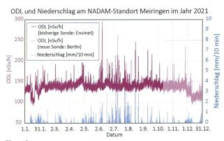
Figur 4: Verlauf der 10 min-ODL-Werte und 10 min-Niederschlagswerte am Standort Meiringen über das Jahr 2021. Die ODL-Spikes jeweils bei einsetzendem Niederschlag sind gut zu erkennen. Am 12.10.2021 wurde die Sonde im Rahmen des Werterhaltes NADAM 2020 ersetzt. Die mit der neuen Sonde gemessenen Werte sind in hellem Rot eingezeichnet.
