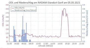
Figur 3: Verlauf der 10 min-ODL-Werte und der Niederschlagsmenge am Standort Genf am 05.05.2021. Am Morgen fiel Niederschlag, am späteren Nachmittag wurden aufgrund des Einsatzes einer Strahlungsquelle in Sondennähe erhöhte ODL-Werte gemessen.
