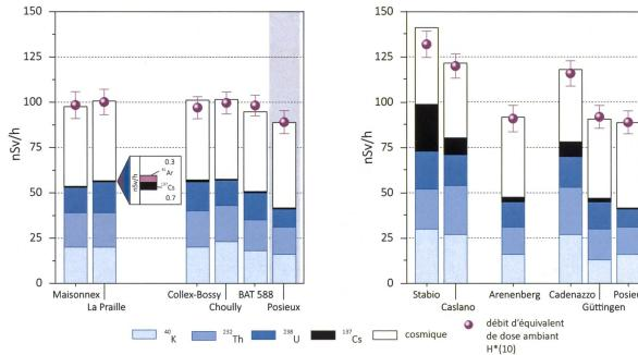
Figure 4: Contributions individuelles au débit d'équivalent de dose ambiant H\*(10) calculées à partir des spectres in situ (distribution supposée homogène des radionucléides dans le sol) mesurés en 2021 au voisinage du CERN ainsi qu'au point de référence de Posieux (en grisé). La mesure globale du débit d'équivalent de dose ambiant H\*(10) avec chambre d'ionisation est également représentée.
