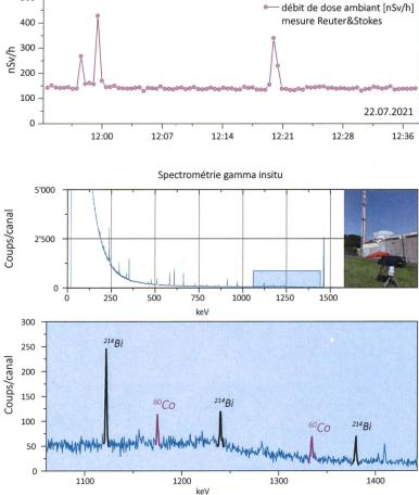
Figure 3 : Valeurs du débit d'équivalent de dose ambiant H\*(10) et spectre de mesure in situ gamma effectués au point «Clôture» situé au voisinage proche de l'enceinte de la centrale nucléaire de Mühleberg en 2021.
