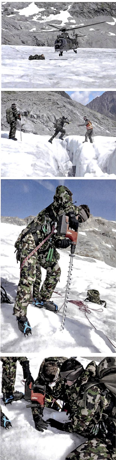
Figur 2: Probennahme mit dem ABC Abw Lab 1, CH-Flugwaffe und Kompetenzzentrum Gebirgsdienst der Armee auf dem Gauligletscher. Pro Probe wurden ca. 2L von trockenem und zerhacktem Eis in Plastikgefässen gesammelt. Die obersten 30 cm Schmelzeis wurde vorher entfernt (Figur von G. Jouvét, 2020).
