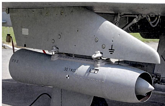
Figur 2: Höhenluftfilter-Aggregate: Detail-Aufnahme eines Sammelgerätes.
