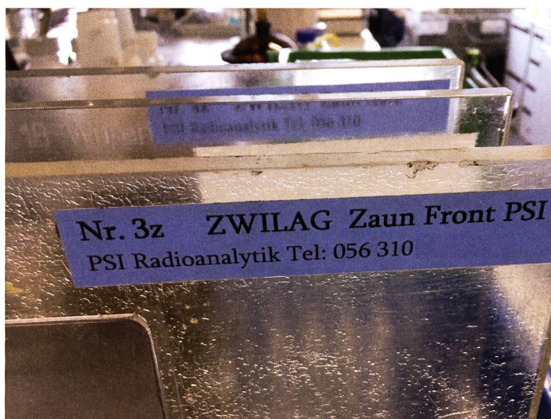
Figur 1 : Staubfangplatten, welche im Labor mit frischer Vaseline-Beschichtung vorbereitet sind, bereit zur Montage an den Sammelstationen (Bild: P. Kramer).
