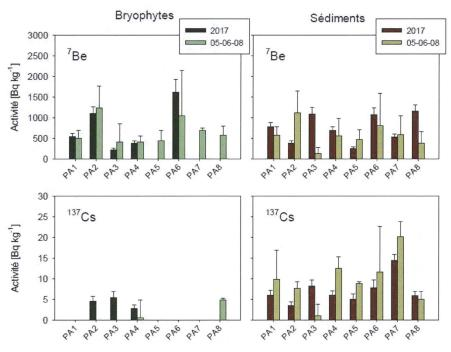
Activités du <sup>7</sup>Be et du <sup>137</sup>Cs dans les bryophytes et les sédiments aux points de rejet du LHC (PA1 à PA8). Les valeurs 05-06-08 correspondent aux moyennes des résultats des campagnes de mesures effectuées en 2005, 2006 et 2008, avant la mise en service du LHC. Il n'y a pas d'échantillon de bryophytes aux points 7 et 8.
