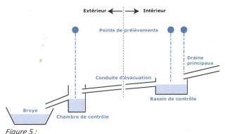
Représentation schématique du système de drainage de l'ancienne centrale expérimentale de Lucens.
