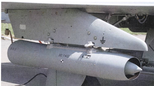
Figur 2: Höhenluftfilter-Aggregate: Detail-Aufnahme eines Sammelgerätes.
