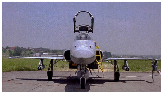
Figur 1 : Höhenluftfilter-Aggregate montiert an den beiden Flügeln eines Tiger sowie Detail-Aufnahme eines Sammelgerätes.
