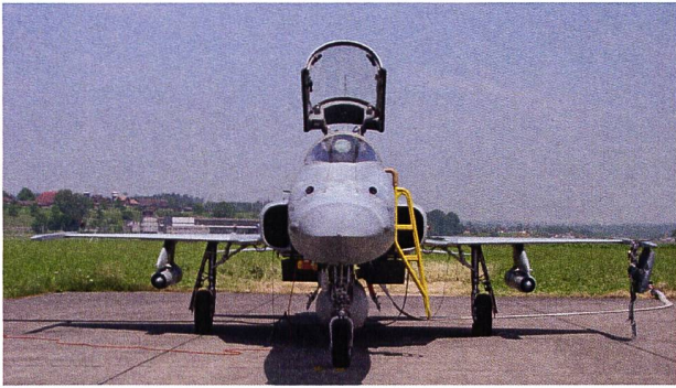
Figur 1 & 2: Höhenluftfilter-Aggregate montiert an den beiden Flügeln eines Tiger sowie Detail-Aufnahme eines Sammelgerätes.
