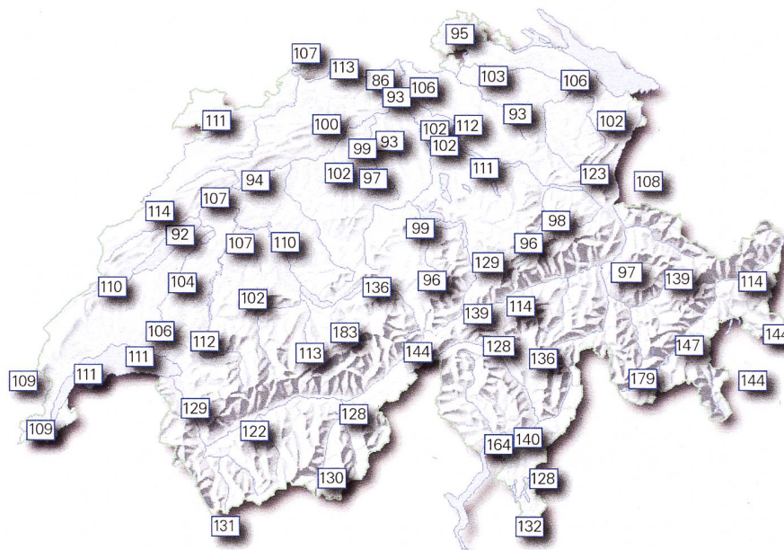
Figur 2: Karte der Jahresmittelwerte 2014 aller NADAM-Sonden in Nanosievert pro Stunde, basierend auf den 10-Min-Werten. Der Jahresmittelwert der Ortsdosisleistung variiert je nach Standort zwischen 86 und 183 nSv/h.
