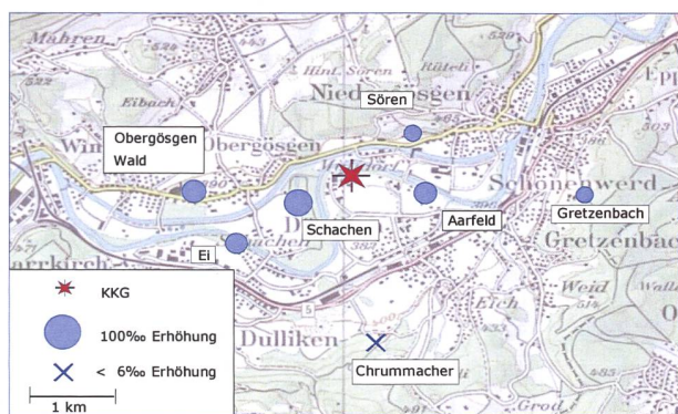
Figur 4: Örtliche Verteilung der Netto \Delta^{14}\text{C} -Werte in der Umgebung des Druckwasserreaktors Gösgen (KKG). Probenahme: 04.07.2013. Die Kreisflächen sind proportional zur Erhöhung gegenüber den unbelasteten Referenzstationen.
