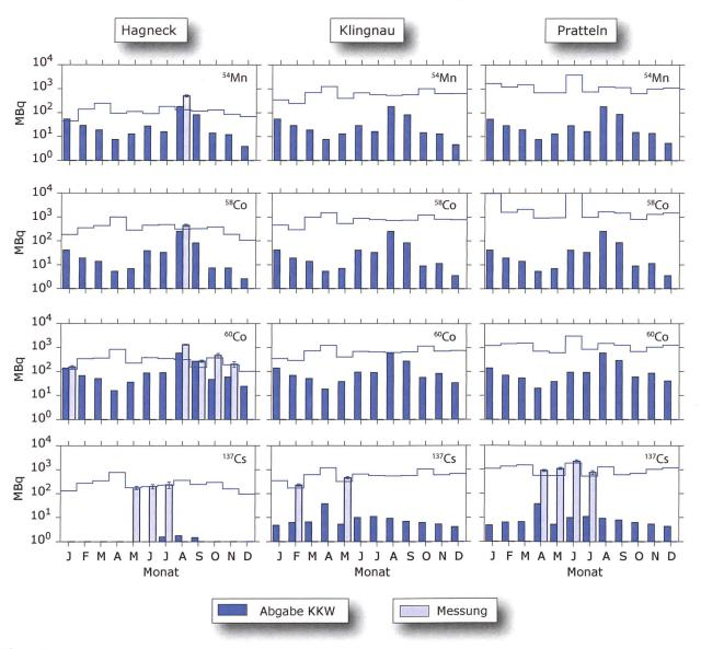
Monatliche Frachten der im Wasser gelösten Radionuklide <sup>54</sup>Mn, <sup>58</sup>Co, <sup>60</sup>Co und <sup>137</sup>Cs an den drei Stationen bei Hagneck, Klingnau und Pratteln im Vergleich mit den kumulierten Abgaben der flussaufwärts gelegenen Kernkraftwerke. Die Messwerte wurden nur dann eingezeichnet, wenn die Bestimmungsgrenze der jeweiligen Messung (blaue Stufenlinie) erreicht wurde. Die Fehlerbalken zeigen den Standardmessfehler der Fracht.
