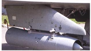
Figur 1 & 2: Höhenluftfilter-Aggregate montiert an den beiden Flügeln eines Tiger sowie Detail-Aufnahme eines Sammelgerätes.
