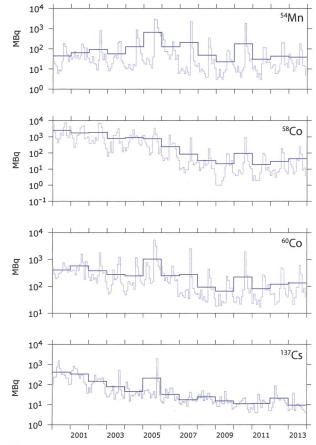
**Figur 4:** Jahres– und Monatsmittel der Abgaben von <sup>54</sup>Mn, <sup>58</sup>Co, <sup>60</sup>Co und <sup>137</sup>Cs aus den Kernkraftwerken während 2000–2013 (Summe der Abgaben aller Kernkraftwerke).
