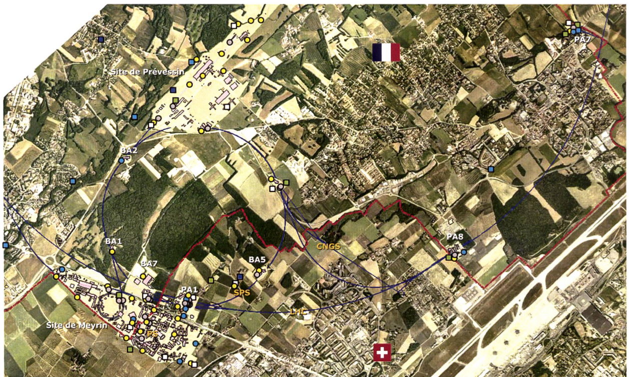
Figure 2: Région frontalière franco-suisse: sites de Meyrin et de Préveessin du CERN, implantation de l'anneau du Super synchrotron à proton (SPS), de l'installation CERN Neutrinos to Gran Sasso (CNGS) et du Grand collisionneur d'hadrons (LHC), situation des stations de surveillance et lieux d'échantillonnage du CERN; ceux qui concernent le territoire suisse y sont tous représentés, excepté le point de collecte des échantillons de l'Allondon qui est hors-carte.
