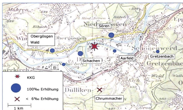
Figur 4: Örtliche Verteilung der Netto \Delta^{14}\text{C} -Werte in der Umgebung des Druckwasserreaktors Gösgen (KKG). Probenahme: 10.7.2012. Die Kreisflächen sind proportional zur Erhöhung gegenüber den unbelasteten Referenzstationen.
