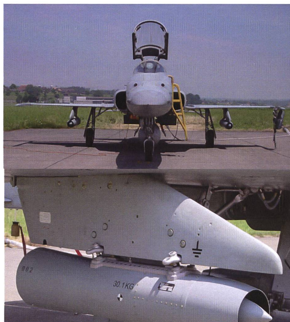
Figur 1 & 2: Höhenluftfilter-Aggregate montiert an den beiden Flügeln eines Tiger sowie Detail-Aufnahme eines Sammelgerätes.
