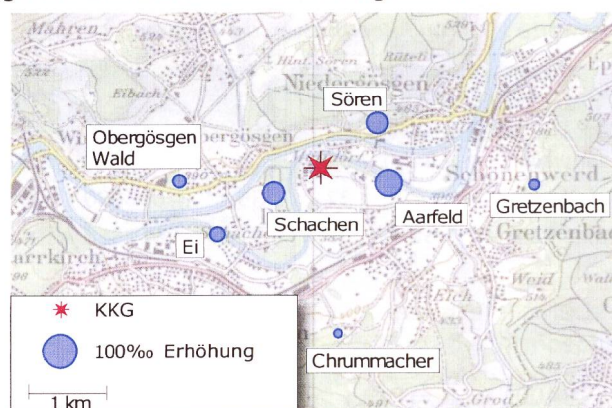
Figur 4: Örtliche Verteilung der Netto \Delta^{14}\text{C} -Werte in der Umgebung des Druckwasserreaktors Gösgen (KKG). Probenahme: 22.6.2010. Die Kreisflächen sind proportional der Erhöhung gegenüber den unbelasteten Referenzstationen.
