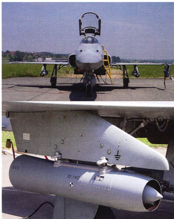
Figur 2 und 3: Höhenluftfilter-Aggregate montiert an den beiden Flügeln eines Tiger sowie Detail-Aufnahme eines Sammelgerätes.
